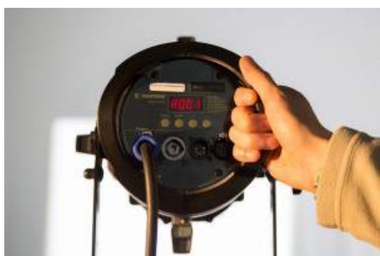
Embase secteur In/out en Neutrik PowerCON et recopie data sur XLR5.
